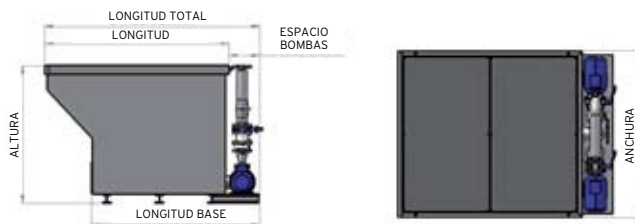
MÓDULO DE DEPÓSITO
