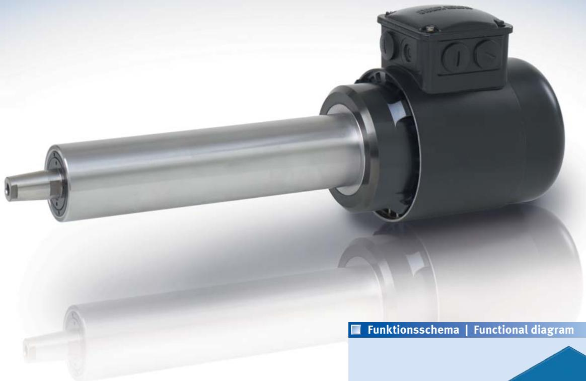
Motorspindeln der Reihe 820 sind luftgekühlte Spindeln. Zum Antrieb ist zwingend ein Frequenzumformer notwendig, um die Spindel bis zur Maximaldrehzahl zu betreiben. Spindelwelle und Motorwelle sind aus einem Stück gefertigt, um das bestmögliche Schwingungsverhalten zu gewährleisten. Für die Herstellung dieser Spindeln verwenden wir nur ausgesuchte Materialien, die auch unter extremen Einsatzbedingungen ein hohes Maß an Genauigkeit und Zuverlässigkeit garantieren.
