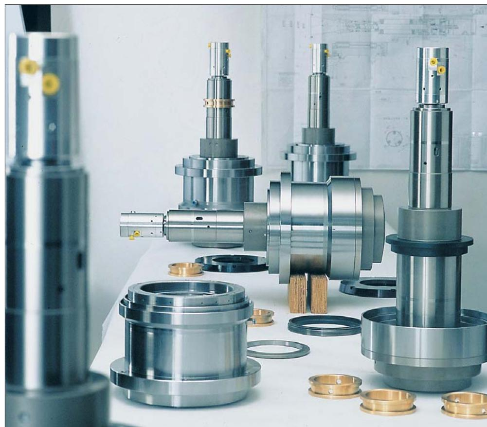
Werkstückspindeln für Schleifmaschinen
