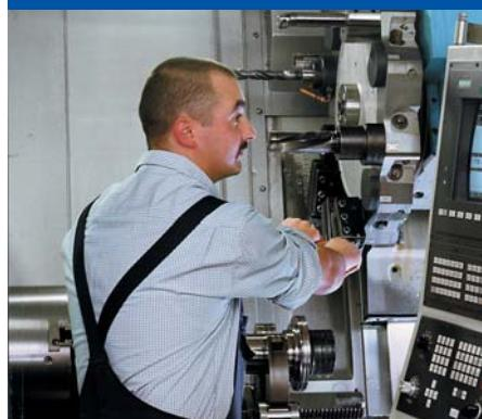
Drehen an CNC-gesteuerter Maschine
